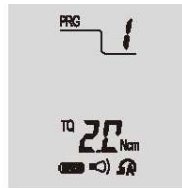
Mode Réciproque : Écran de réglage d'angle de rotation avant
