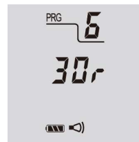
Anzeige zur Einstellung des reziproken Rückwärtsrotationswinkel
