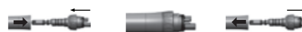
Fig.1 Installer le raccord, Fig.2 Tourner le raccord afin de vérifier la connexion, Fig.3 Retirer le raccord
